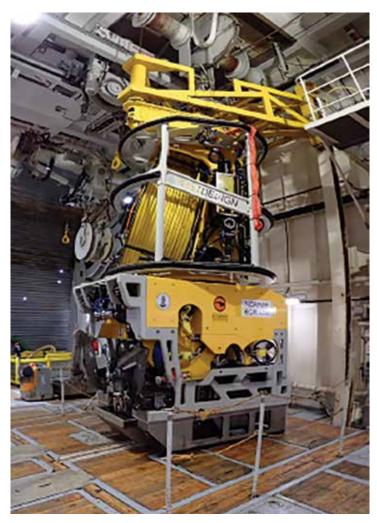
ÆGIR 6000 是一种遥控潜水器 ROV, 旨在供科学家进入和研究海底。它适用于高达 6000 米的深度。 ÆGIR 由挪威卑尔根大学
